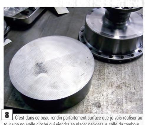
**8** C'est dans ce beau rondin parfaitement surfacé que je vais réaliser au tour une nouvelle cloche qui viendra se placer par-dessus celle du tambour.
