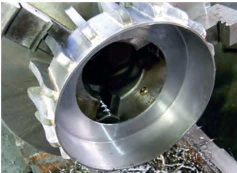
**15** Obligation de repasser l'enjoliveur au tour et de réuser l'intérieur, car soudures et brasures peuvent déformer l'ensemble...
