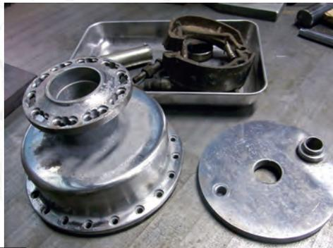
**2** Nettoyage en profondeur avec suppression de la couche de rouille. Le chrome n'a pas résisté aux attaques du temps et de la météo!
