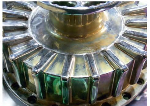
**17** Sur cette photo, on voit le résultat final. J'ai soudé l'enjoliveur à la cloche de frein avec de la soudure à froid haute résistance maintenue à la presse. En effet, il est très difficile de braser une telle pièce, car il faudrait beaucoup de matière d'apport.
