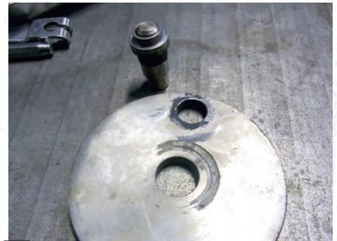
**3** Désolidarisation de la vis de fixation de la plaque du tambour afin de pouvoir travailler correctement.
